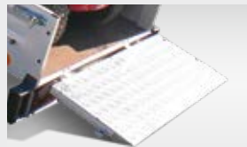
Rutschfestes und verstärktes Alu-Riffelblech
