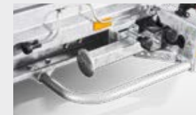
Stabiler Schutzbügel bietet sicheren seitlichen Anfahrerschutz und Aufstiegshilfe.
