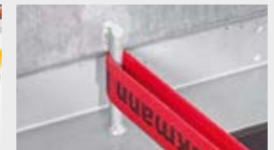
Verzurrleisten in Bordwand integriert
