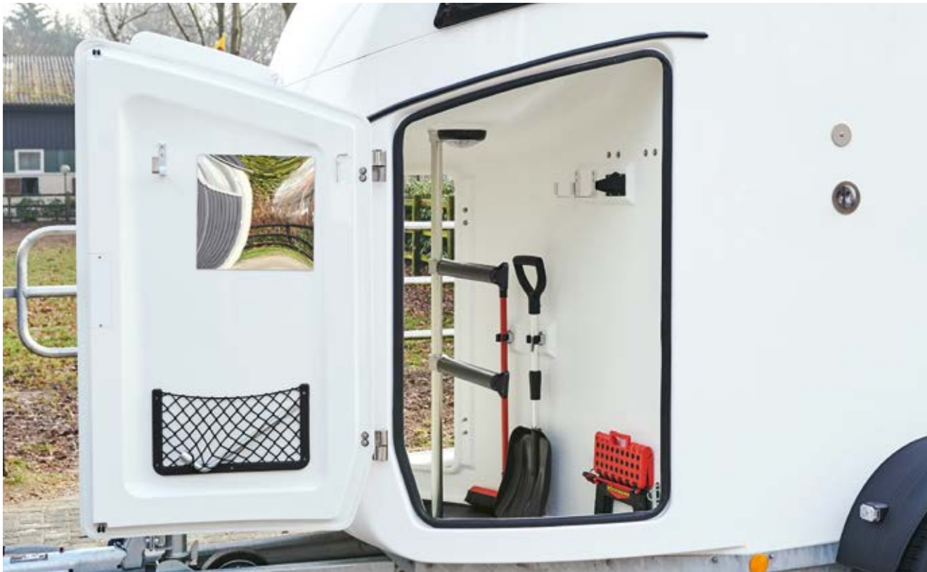
Komfortable Bedienung und umfangreiche Serienausstattung der Sattelkammer durch Türfeststeller sowie Teleskopbesen, Kunststoffschaufel, Türnetz, Spiegel, Gertenhalter, Futtertröge, große Trensenhaken, Padhalter, LED-Licht und Klapphocker mit Sicherung.
