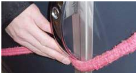
KEIN VERFANGEN DES STRICKS durch anliegende Türgriffe
